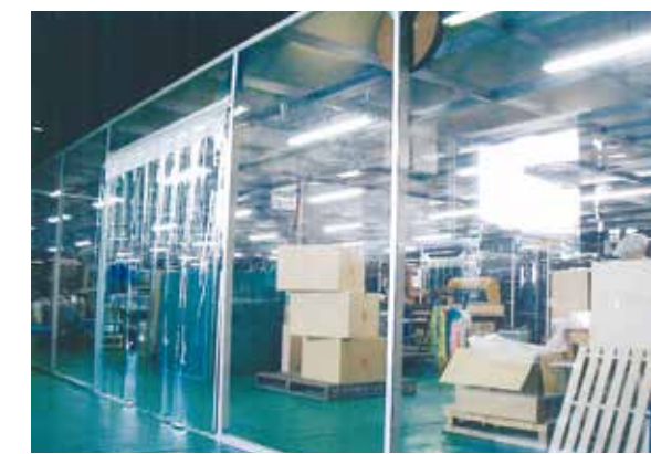
保管庫ビニールブース
